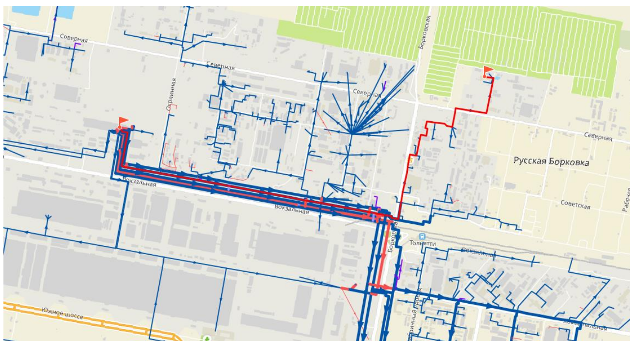
Рисунок 2.9 - Путь теплоносителя по направлению от ТЭЦ ВАЗ до потребителя «Северная, 12»
